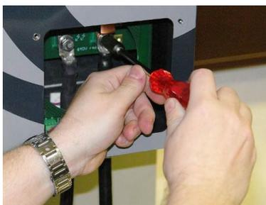
Beispielbild oben: Kabelanschluss durch die Öffnung auf der rechten Seite. Bei der Befestigung wenden Sie bei den Edelstahl M8 Schrauben bitte ein Drehmoment von 9-10 Nm an. Die Sicherungen befinden sich hinter der linken Abdeckung.
