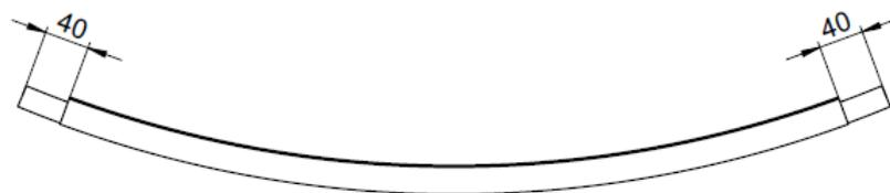
Abb. 26: Innenbogen mit mittig ausgerichtetem Isolierprofil
