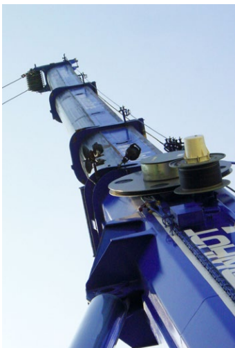
Schleifringkörper in Baumaschine
